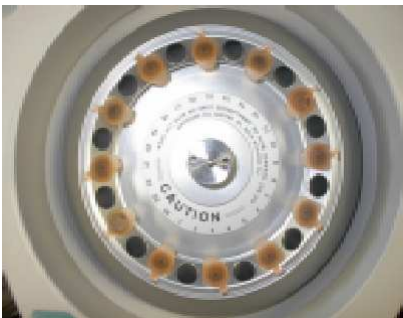
Abbildung 1: Gleichmäßig beladener Rotor
